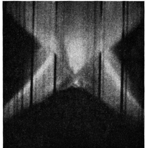
Abb. 2. Schmieraufnahme einer Entladung in 13 Torr H 2 . Die innere Front der Zone I ist hier unscharf bzw. mehrfach. Die reflektierte Front ist nur angedeutet.
